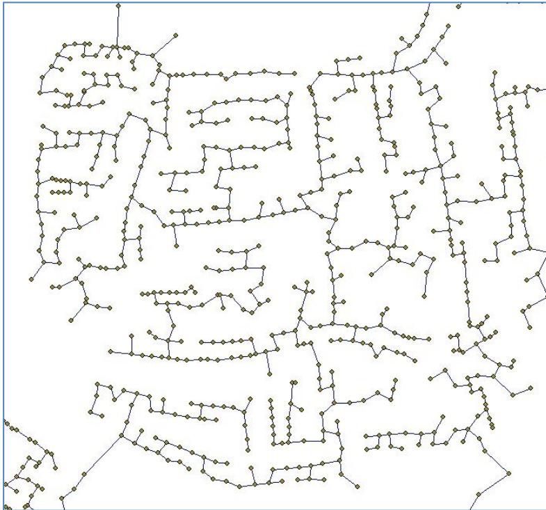
Abbildung 18: Spannbaum als kürzeste Verbindung zwischen den Hauskoordinaten
